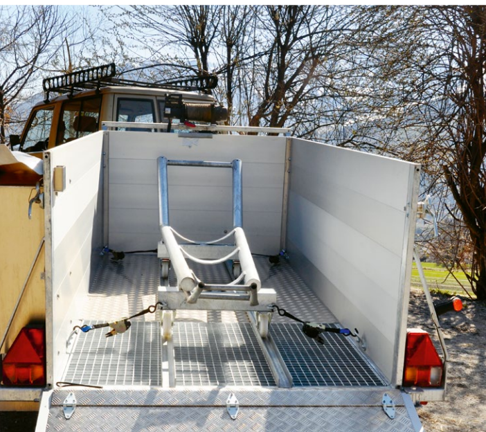
Der für den Transport des toten Rindes zugelassene T-Trailer mit dem Schragen, auf den das entblutete Tier gelegt wird. Solche Anhänger ermöglichen den hygienischen Transport des Schlachtkörpers in ein nahegelegenes Schlachtlokal.
