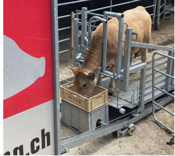
Das an die MSE-200A gegliederte Selbstfangressgitter ist so konstruiert, dass es auf Schienen aus dem Anhänger herausgefahren und abgekoppelt und am Schlachttag wieder angekoppelt werden kann.
