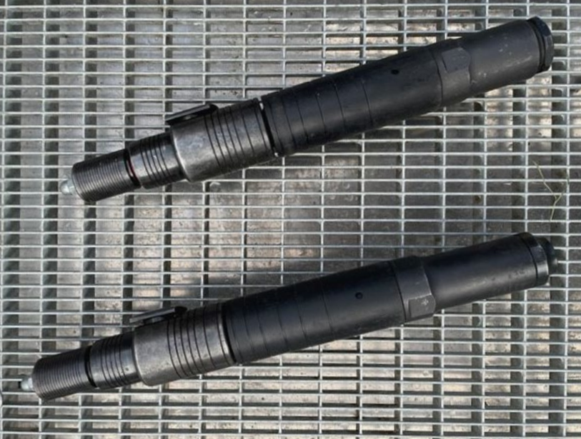
Das Bolzenschussgerät Schermer KL ist eines der Geräte, die über eine Bolzenaustrittslänge von 12cm verfügen. Es hat kein Rückholssystem, dafür mehr Schlagkraft (Joule).
