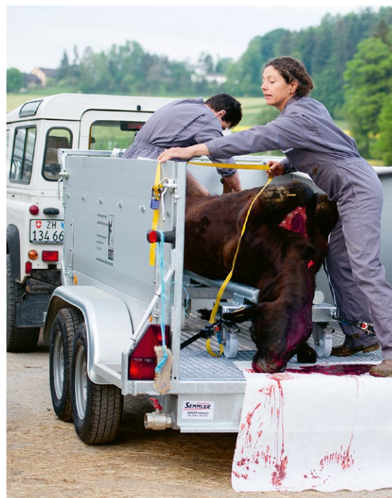
Der für Weidetötungen in Deutschland angefertigte T-Trailer besteht grösstenteils aus Aluminium und entspricht den Vorgaben der EU-Hygieneverordnung. Er kann sowohl an einen PKW als auch an einen Traktor angehängt werden. Der Anhänger eignet sich auch für den Transport von Tieren aus Hofötung.
